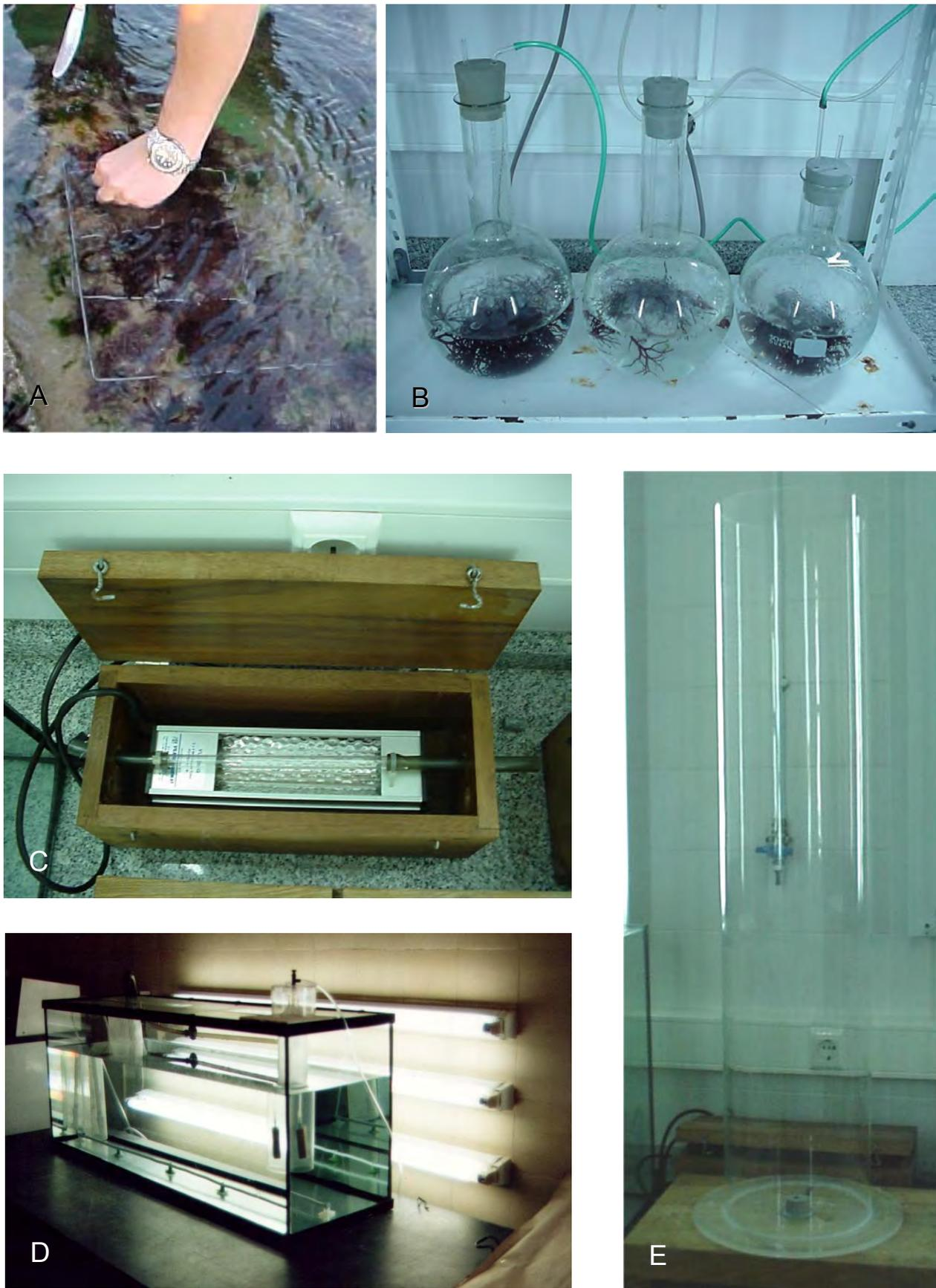
**Figura 2.4** – Colheita e cultura laboratorial de carragenófitas: colheita das algas inteiras com auxílio de uma faca (A); cultura em balões de vidro (B); equipamento de esterilização por UV (C); cultura de manutenção em aquário (D); cilindro de “plexiglass” para produção de biomassa (E).
